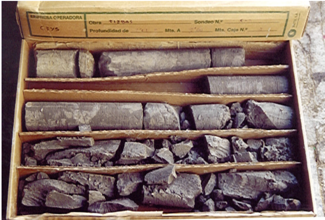
Sondeo 5, caja 3; de 6,00 a 9,00 m. Margas grises que vuelven a aparecer fracturadas en un tramo.
