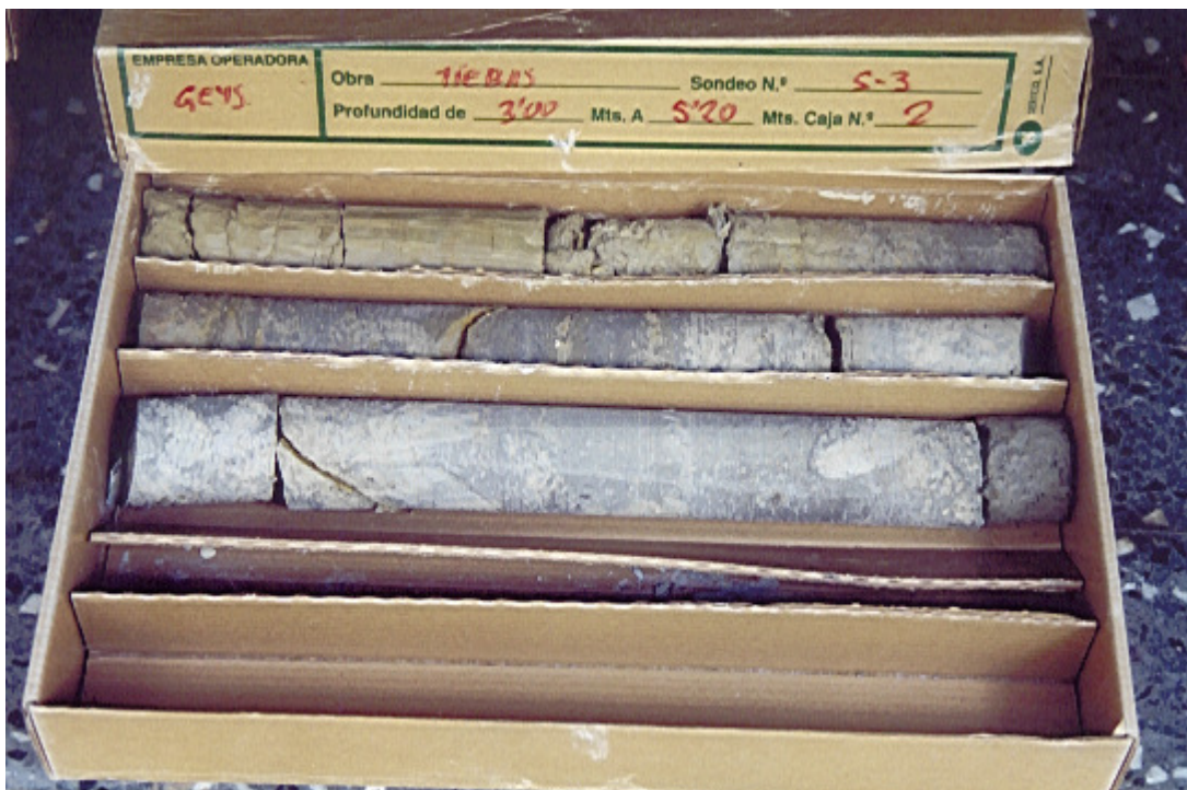
Sondeo 3, caja 2; de 3,00 a 5,20 m. Transición de los suelos de alteración a las margas grises.
