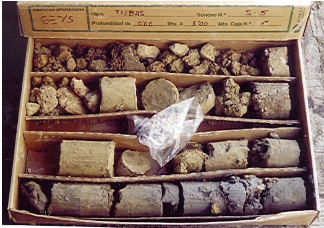
Sondeo 5, caja 1; de 0,00 a 3,00 m. Tramo inicial de glacia, suelos de alteración de margas y transición a las margas grises.
