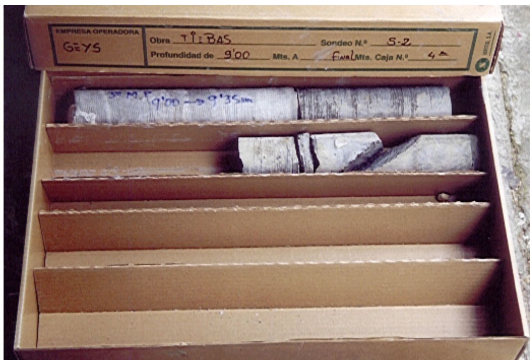
Sondeo 2, caja 4; de 9,00 a 10,00 m. Final del sondeo en las margas grises en las que se observa una diaclasa con fuerte buzamiento.
