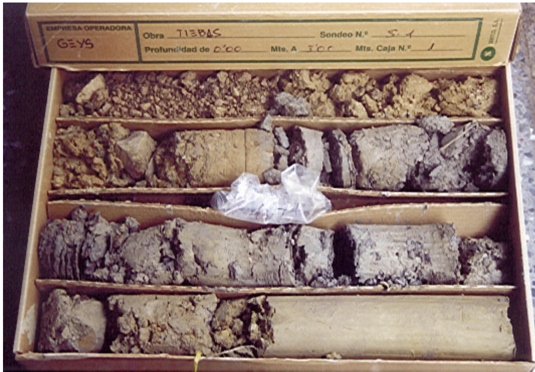
Sondeo 1, caja 1; de 0,00 a 3,00 m. Tramo inicial de terraplén y transición a los suelos arcillosos originados por alteración de las margas grises (CL).
