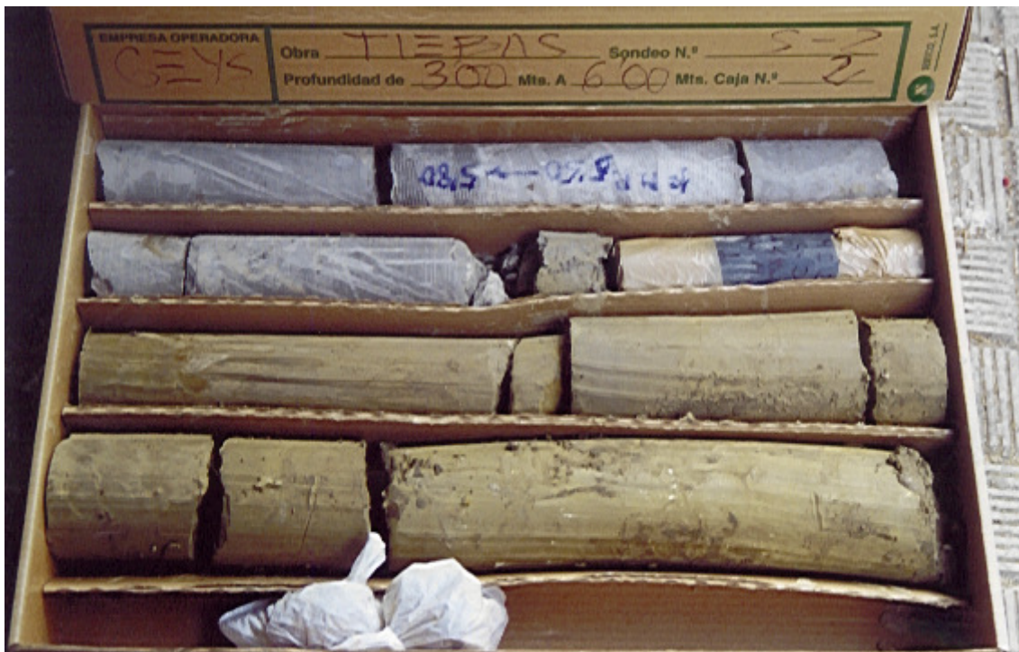
Sondeo 2, caja 2; de 3,00 a 6,00 m. Transición de las arcillas de fondo de valle a los suelos de alteración de las margas grises y a las margas sanas.
