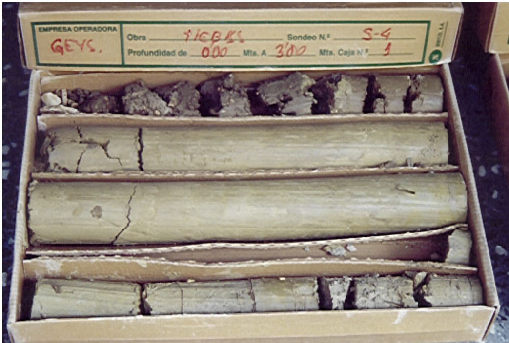
Sondeo 4, caja 1; de 0,00 a 3,00 m. Tierra vegetal con restos de glacia, transición a suelos de meteorización de las margas (CL) y transición a las margas.
