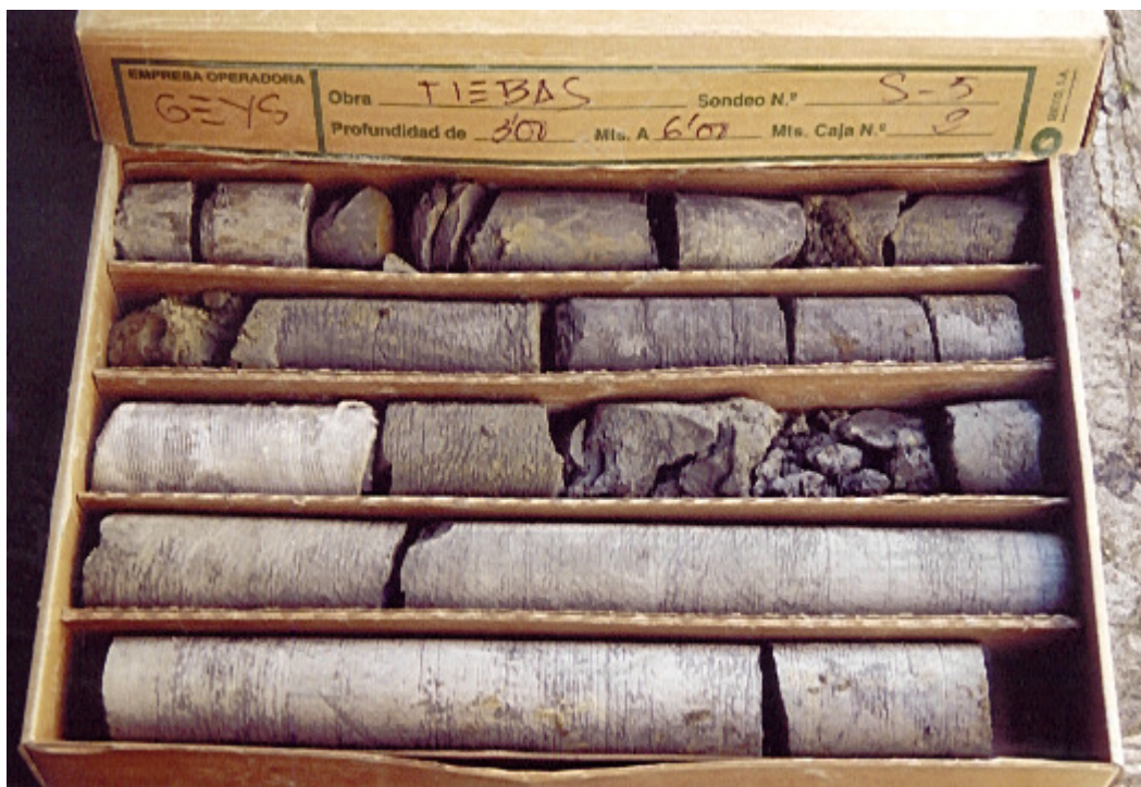
Sondeo 5, caja 2; de 3,00 a 6,00 m. Tramo inicial de las margas grises algo alteradas y fracturadas.
