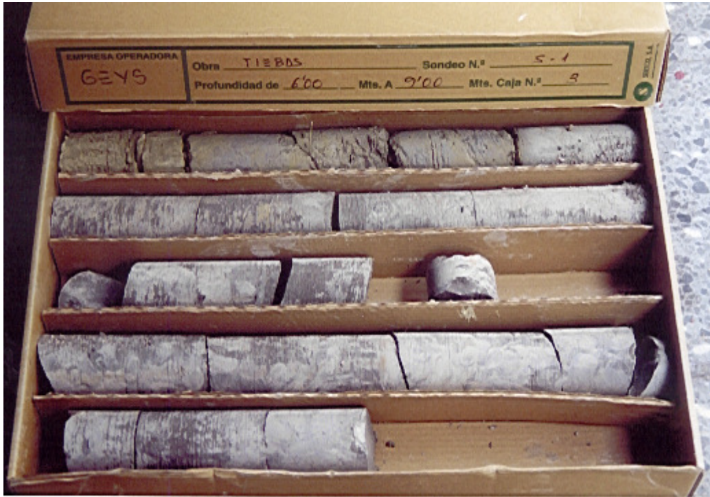
Sondeo 1, caja 3; de 6,00 a 9,00 m. Fin de la transición a las margas grises que comienzan con algunos planos de fractura con unos 20° de buzamiento.
