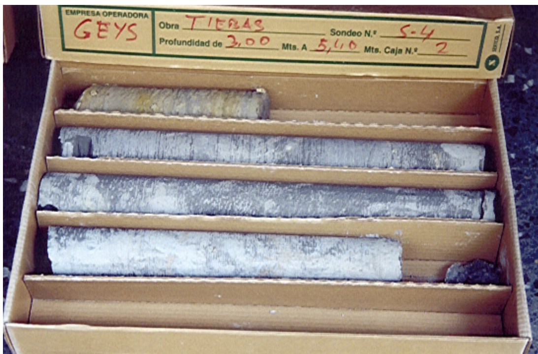
Sondeo 4, caja 2; de 3,00 a 5,40 m. Margas grises de Pamplona.
