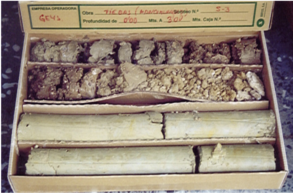
Sondeo 3, caja 1; de 0,00 a 3,00 m. Tramo inicial de glacis, arcillas marrones con grava fina, y transición a los suelos de alteración de margas (CL).
