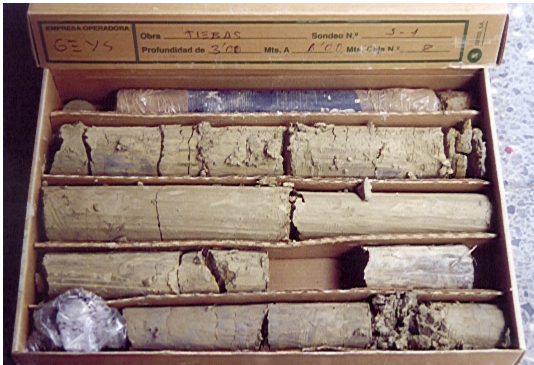
Sondeo 1, caja 2; de 3,00 a 6,00 m. Tramo de suelos arcillosos (CL) y transición a las margas grises sanas.
